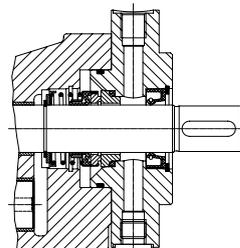
带有机械密封和液封连接孔的泵
