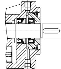
带有双旋转轴密封和液封连接孔（淬火）的泵
