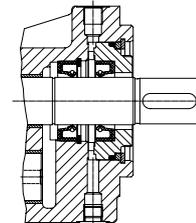
用于真空工况下带有双旋转轴密封和液封连接孔（淬火）的泵
