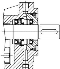
用于真空工况和普通工况的带有三旋转轴密封和液封连接孔的泵
